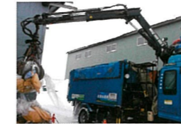
多量の廃棄物、重量物をクレーンで掴み取るクラム車両
